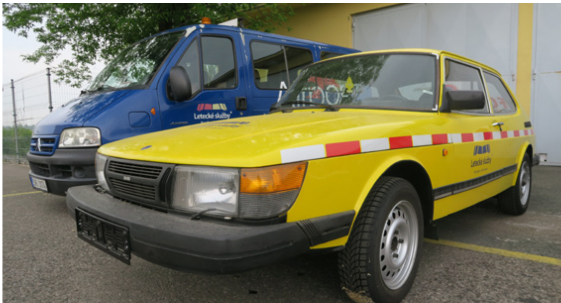
Vozidlo SFT SAAB 900 pro měření koeficientu tření betonové RWY 15L/33R.
