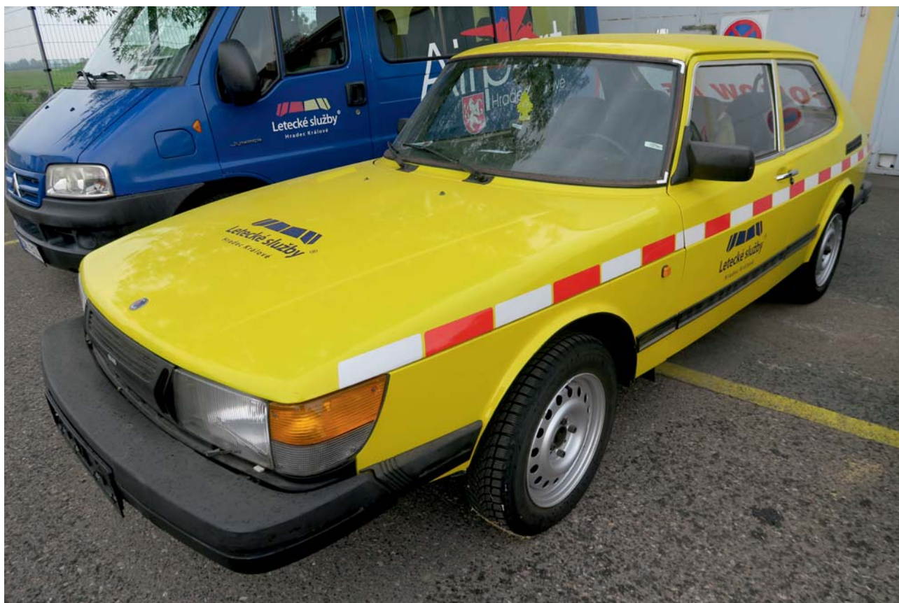
Obr. - Zařízení pro provozní měření koeficientu tření RWY (SFT SAAB 900)
