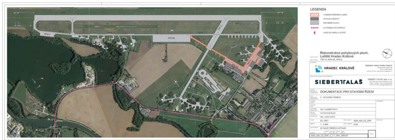
Obr. - Rozsah uvažované rekonstrukce pojezdových ploch
