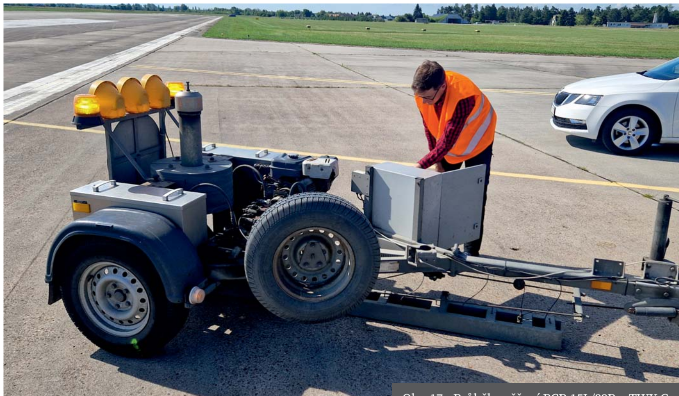
Obr. 17 - Průběh měření PCR 15L/33R a TWY C.
